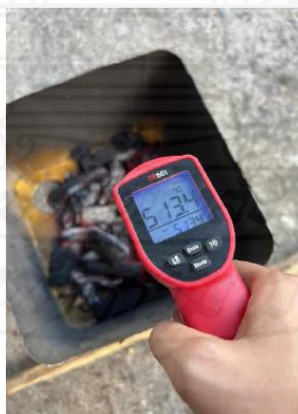
ภาพที่ 5 การวัดค่าอุณหภูมิความร้อนของถ่านขณะเผาไหม้
