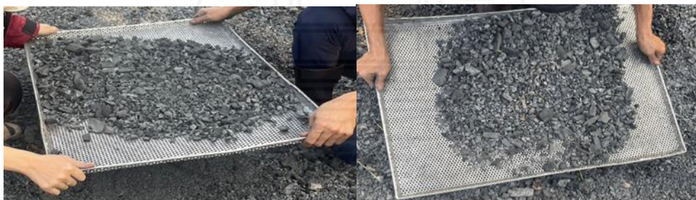
ภาพที่ 1 การนำเศษถ่านที่ใช้แล้ว มาทำการร่อนด้วยตะแกรง
